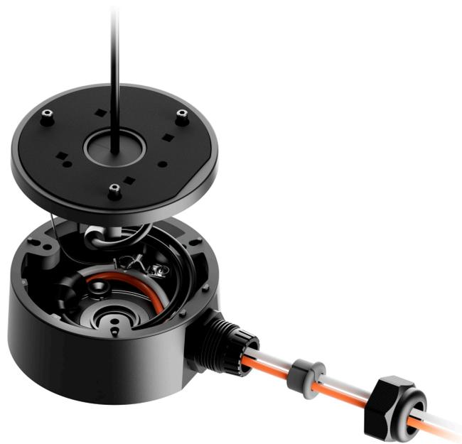
JunctionBox è dotato di un filo di montaggio per fissare il coperchio durante l'installazione. Il filo di montaggio impedisce al coperchio di cadere dalla scatola di montaggio della telecamera finché non viene fissato con le viti. Il filo di montaggio è collegato al terminale di messa a terra.
