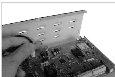
Collegare i faston del cavetto in dotazione sui morsetti C e NC dello switch di tamper (il tamper di centrale è programmato di fabbrica come NA) e il connettore sulla scheda centrale in corrispondenza del morsetto TAMPER.
