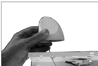
a. Inserire l'antenna nell'apposito foro previsto sul contenitore metallico.
