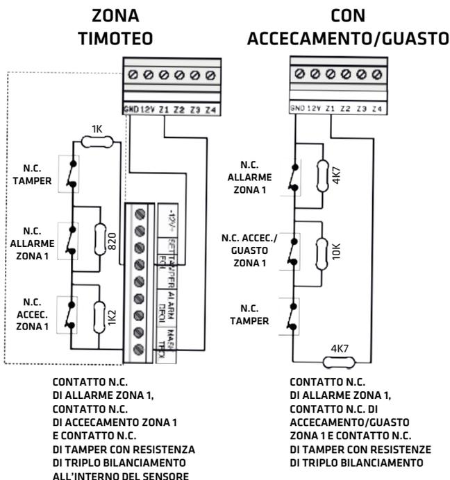
Nella configurazione a triplo bilanciamento con guasto/accecamento, è possibile utilizzare, oltre alle resistenze di bilanciamento standard previste dalla centrale, quelle previste dalle centrali Combivox serie 2012 (vedi esempio per Zona Timoteo).
