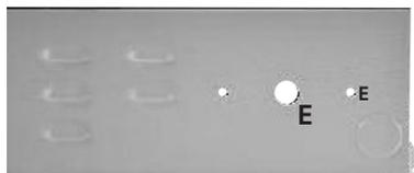
**E** Fori per il montaggio dell'antenna LTE e 2 fori per il fissaggio della calotta ABS antimanomissione
